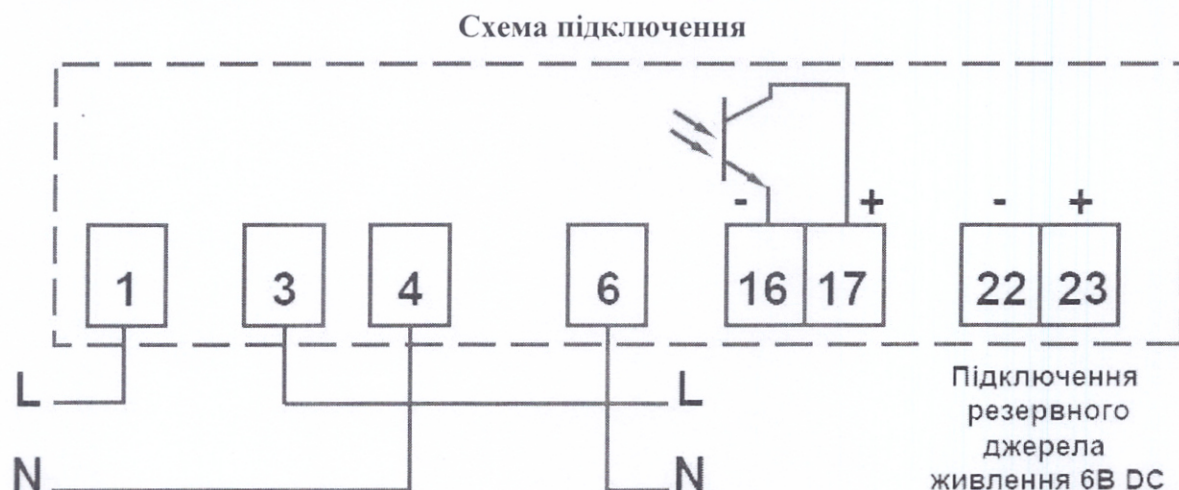
Рисунок 13 – Схема підключення лічильників електричної енергії НІК 2102... у виконанні з електронним відліковим пристроєм
