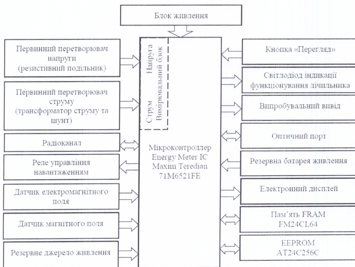
Рисунок 1 – Структурна схема лічильників електричної енергії НІК 2102... у виконанні з електронним відліковим пристроєм
